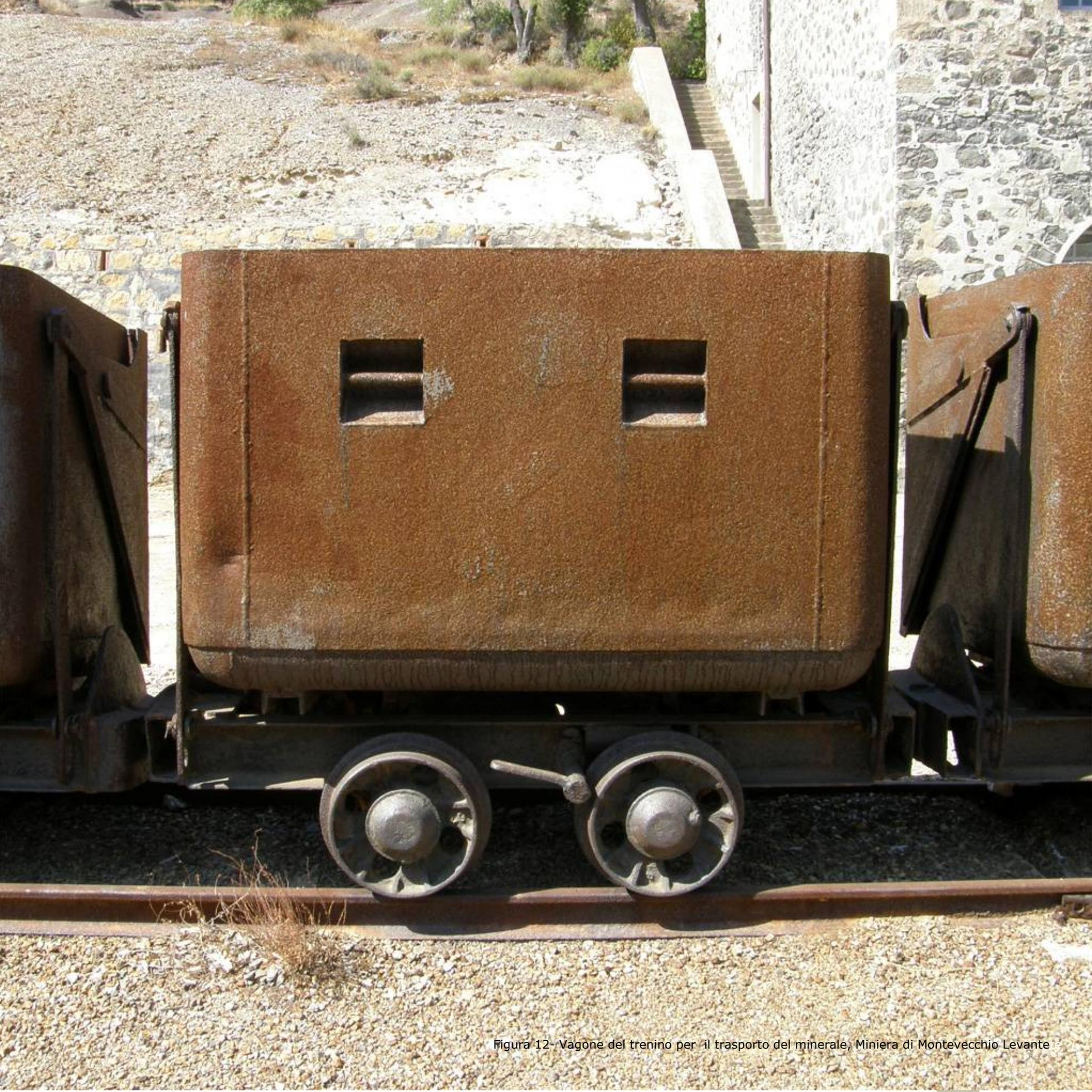
Figura 12- Vagone del trenino per il trasporto del minerale, Miniera di Montevecchio Levante
