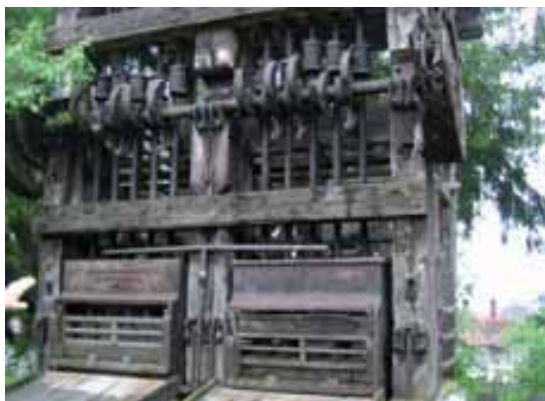
Figura 3. Macchine a vapore per macinare il grezzo, esposte a cielo aperto, presso le gallerie di età romana della miniera aurifera di Alburnus Maior (Rosia Montana, distretto di Alba)
